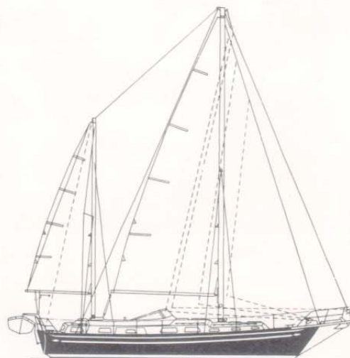
Hallberg Rassy 41' Exklusiv båt för bekväm långfärdssegling. Depl. 10 ton. 75 hk Volvo diesel.
